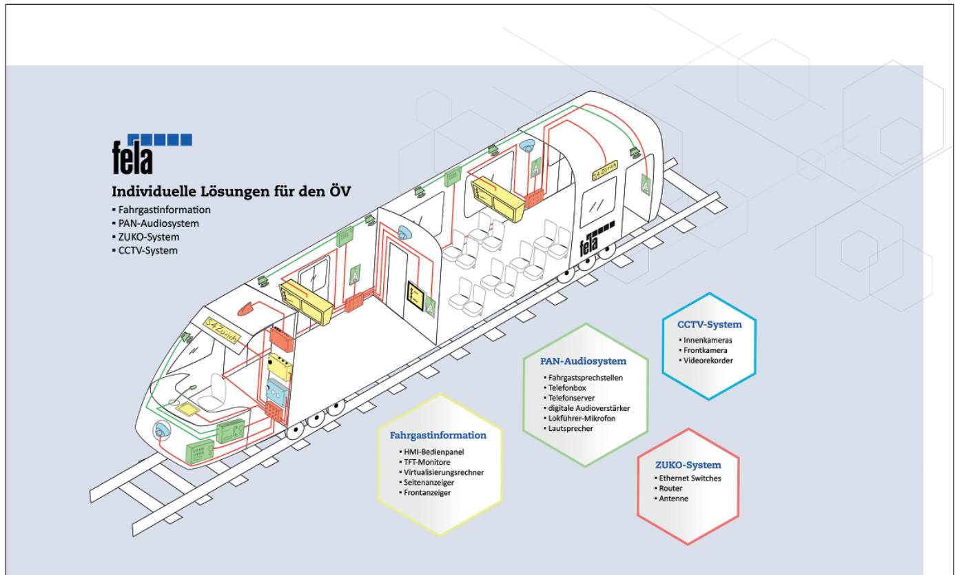
Abb. 2: Übersicht aller Teil-Komponenten, die moderne Fahrgastinformationssysteme beinhalten.
